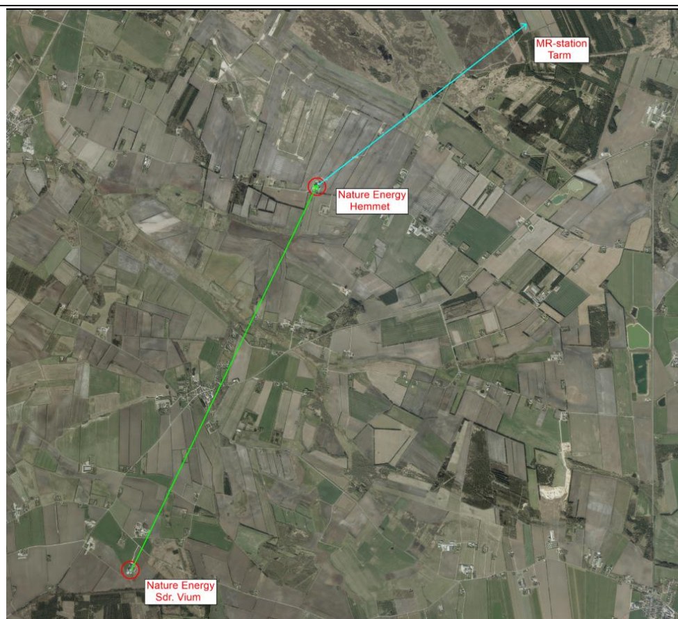
Figur 1.3: Oversigt over sammenhængende biogasnet for biogasanlæggene Nature Energy Hemmet og Nature Energy Sdr. Vium. Biogas fra Nature Energy Sdr. Vium sendes i rørledning (grøn pil) til opgraderingsanlægget på Nature Energy Hemmet, hvor det oprensede og tryksatte biometan sendes i rørledning (blå pil) til MR-station ved Tarm, hvor gasen injiceres i naturgasnettet.
