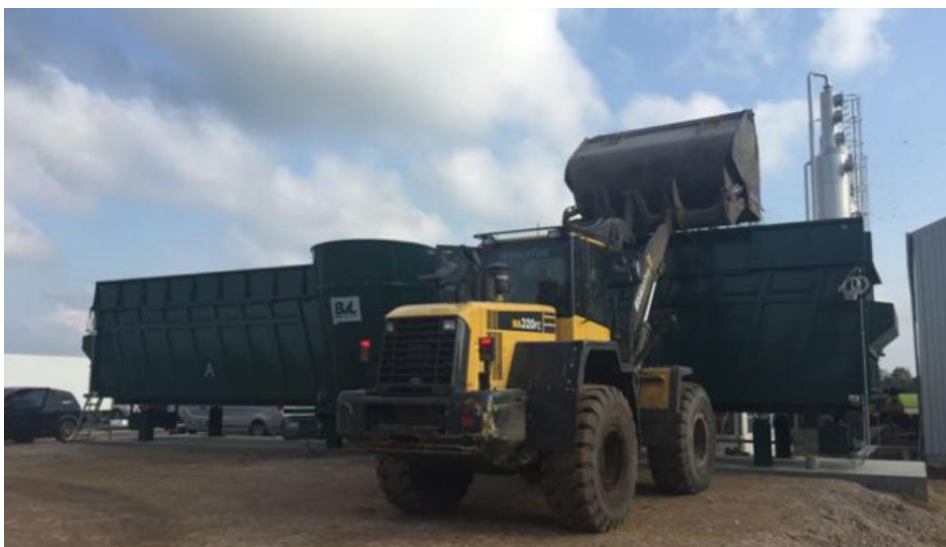
Figur 2.1: Eksempel på uden-dørsopstillet faststofindtag "indføder" som fyldes med frontlæsser. Produkt V-Bio Combi 2D.[Enter Text]
